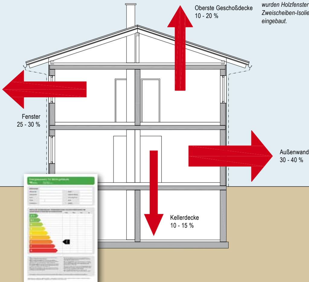
Für die Umsetzung des **Sanierungszieles Kategorie »B«** der Musterhaussanierung werden die einzelnen Teile der Gebäudehülle mit entsprechenden Dämmstärken ausgestattet und die Isolierglasfenster durch qualitativ hochwertige Fenster mit Dreischeiben-Wärmeschutzverglasung ersetzt. Durch die Sanierungsmaßnahmen wird der Energiebedarf auf ein Fünftel gesenkt.
